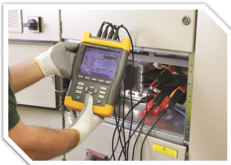
2.2.2-rasm. Elektr tarmoq parametrlarini tezkor aniqlash jarayoni.
