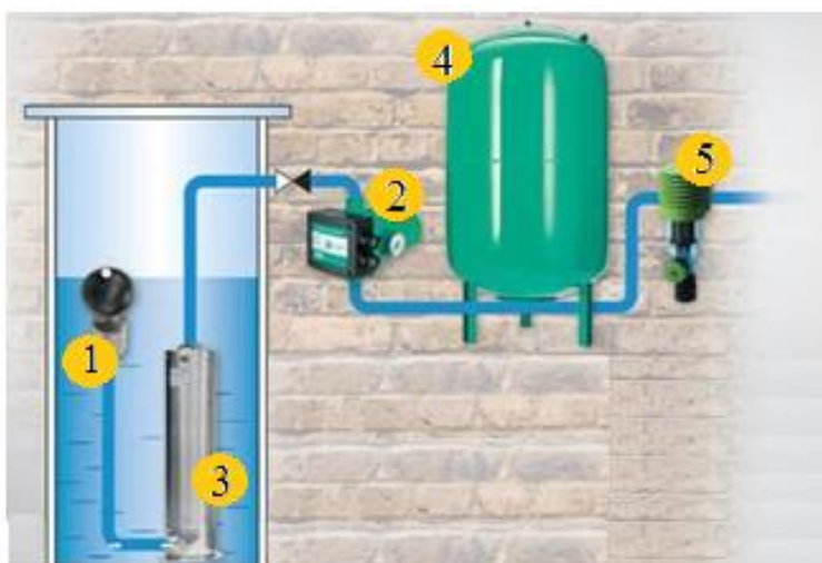
7.3.5-rasm. Cho'ktiriluvchi nasos va uning asosiy qismlari.
