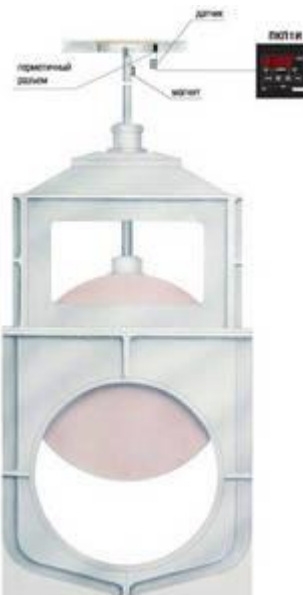
7.4.3-rasm. Cheklovchi uzgichlarni qo‘llamay zadvijkalar ishini nazorat qilish imkonini beruvchi asbobning takomillashgan varianti
