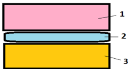
2.3.4-rasm. Suyuqlikli tinchlantirgich(1-aylanuvchi qism;2-suyuqlikli tinchlantirgich; 3-qo'zg'almas qism)
