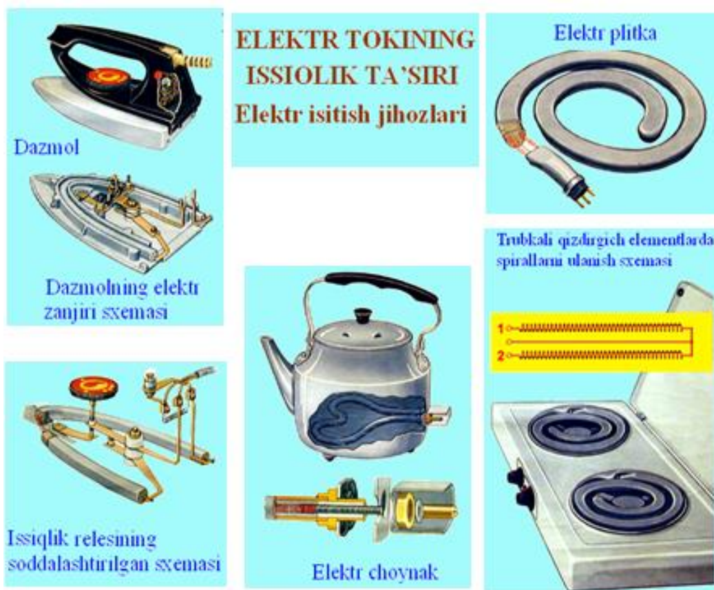
1.1.5-rasm. Elektr isitish jihozlari.
