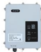
GR110 rusumli geodezik asbob koordinatalar, tezlik vektori xamda GNSS, GLONASS, GPS signallar bo'yicha joriy vaqt datchigi sifatida geodezik va navigatsion masalalarni echishga mo'ljallangan.
